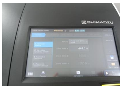
Сурет 1 – UV-Vis спектрофотометрінің көмегімен DOBI анықтау жұмысының барысы
