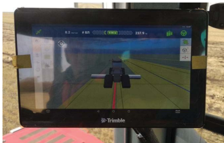
Рисунок 2 – Вид курсоуказателя автоматического вождения «Trimble AgGPS Autopilot» установленного в тракторе К-744Р2
