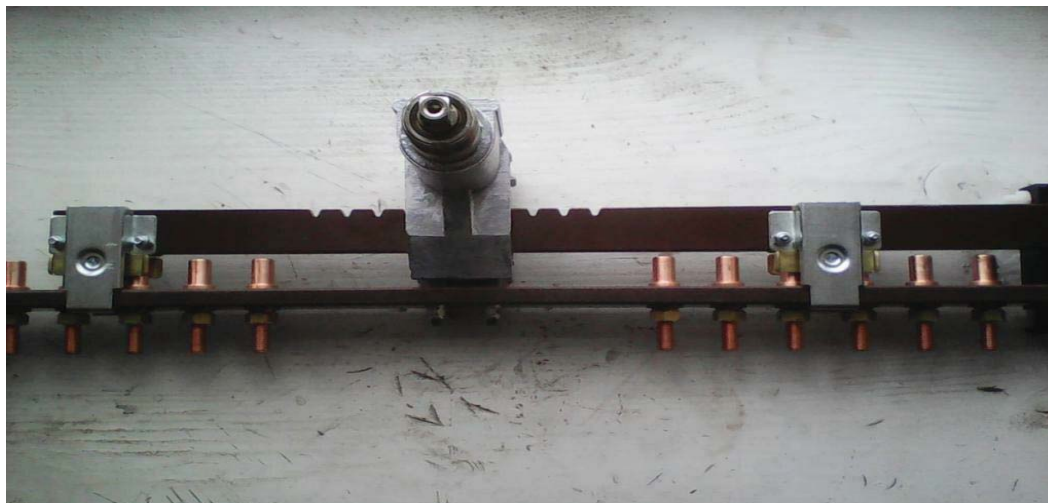
Рисунок 1. Трансформаторный переключатель напряжения
