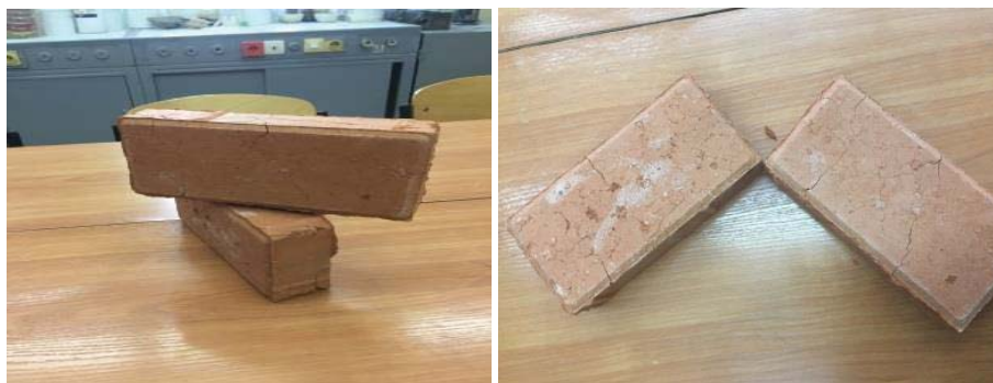
Рисунок 3. Образцы керамических брусчаток на основе сырьевой композиции глина – тальковая порода
