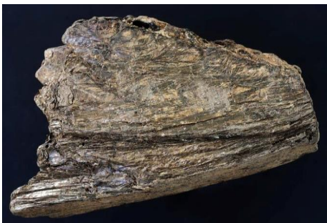
3-сурет - Вермикулит рудасы мен оның қопсытылған түрі
