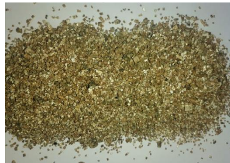
3-сурет - Вермикулит рудасы мен оның қопсытылған түрі
