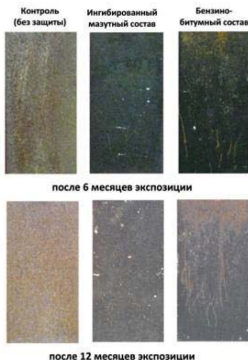
Рисунок 5 – Вид пластин после атмосферных испытаний
