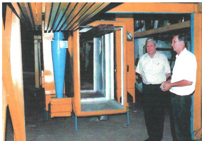
Рисунок 1 – Общий вид установки для нанесения порошкового покрытия на арматуру
