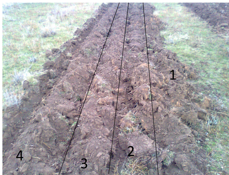
Рисунок 2 – 1; 2- почва обработанная обычным плугом; 3- почва обработанная плугом с пластинчатым рыхлящим элементом; 4- почва обработанная плугом с рыхлящим элементом в виде вогнутой секирообразной кривой.
