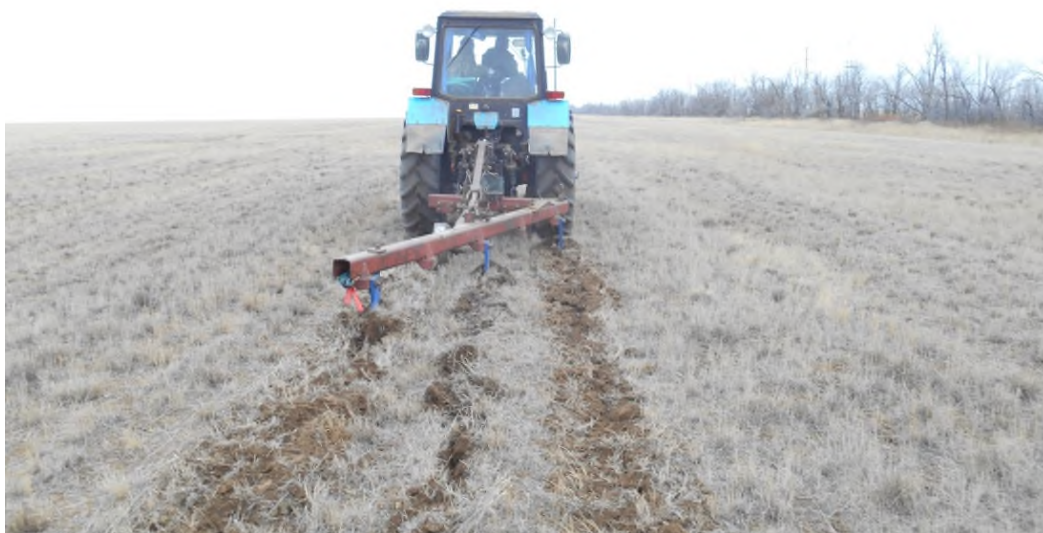
Фото15 –Осеннее щелевание пласта многолетних трав орудием «РАНЧО»
