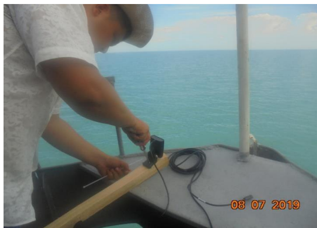
Монтаж датчика гидролокатора эхолота
