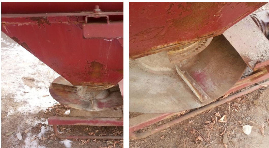
Сурет 1. Минералды тыңайтқыштарды шашқыштардың коррозиялық тозуы
