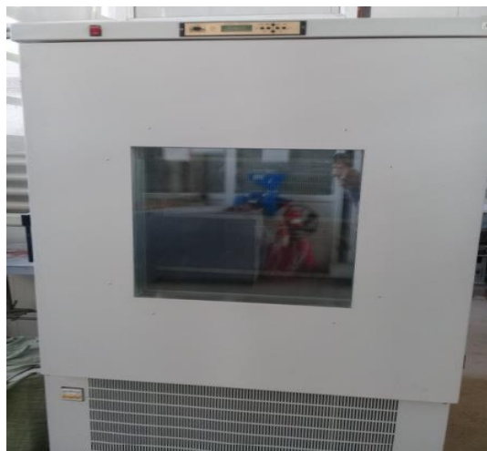
Сурет 5. Жылыту және суыту камерасы. КТХ.
