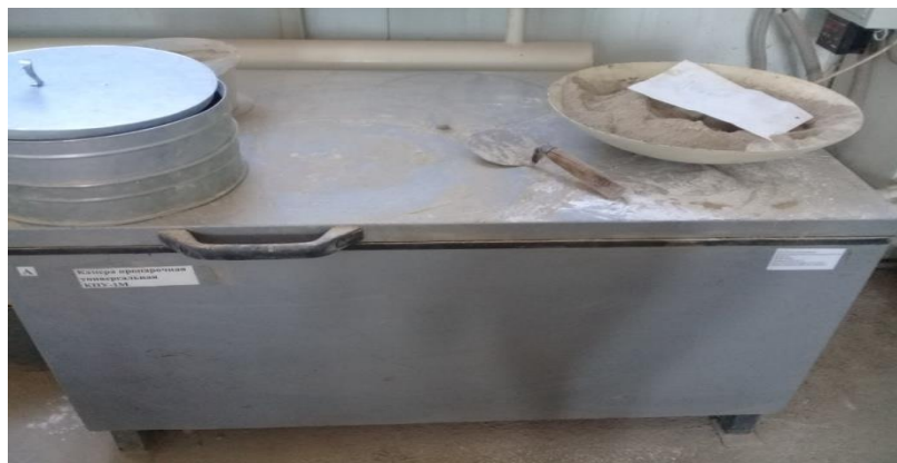
Сурет 3. Материалдың суға төзімділігін анықтау камерасы. КПУ – 1М
