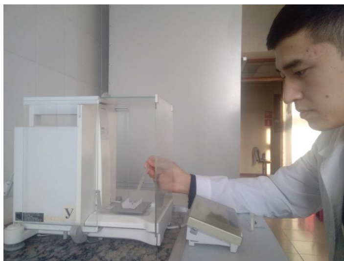
Рисунок 1. Взвешивание отобранных проб икринок осетровых рыб на весах «XS204»
