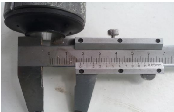
Рисунок 3.16 - Расточенный внутренний диаметр алюминиевой втулки сайлентблока
