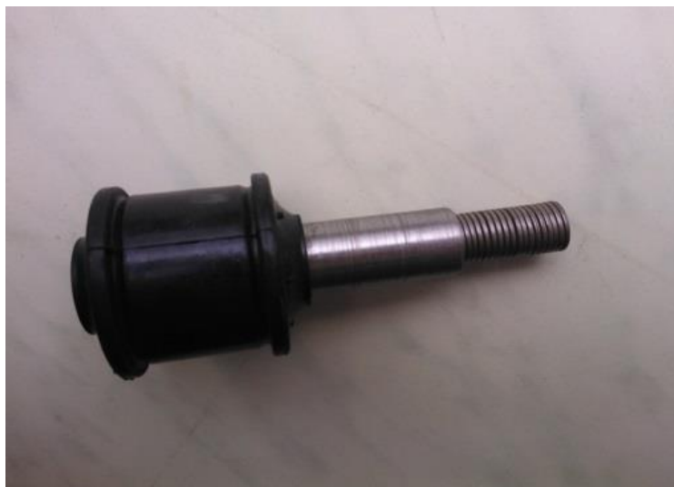
Рисунок 4.10 - Сайлентблок амортизатора новой конструкции с пружинным вкладышем перед сборкой
