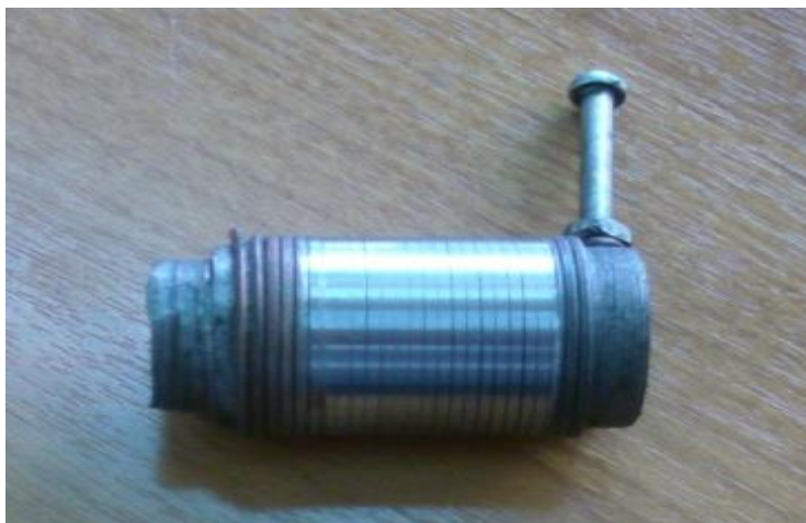
Рисунок 2.3 - Пружинный вкладыш на оправке после круглого шлифования
