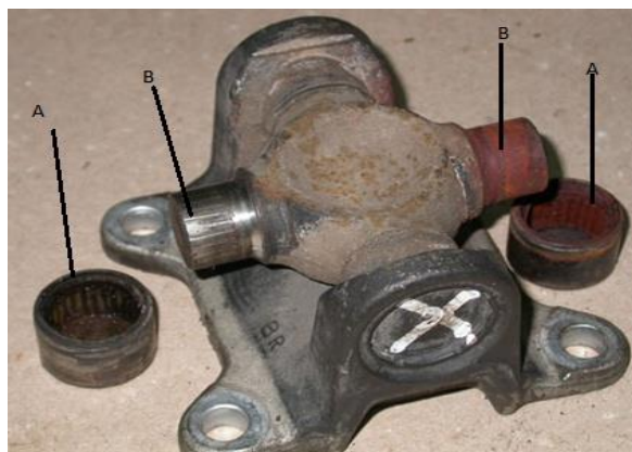
Рисунок 4.4 - Внешний вид изношенных деталей («ложное бринелирование») подшипникового узла крестовины: А) – обойма подшипника; В) – цапфа крестовины.
