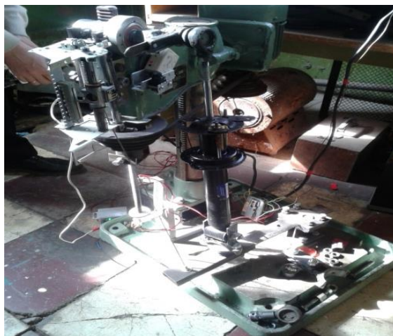
Рисунок 2.5 - Экспериментальная установка самостоятельного изготовления для исследования амортизаторов по усилию сжатия и отбоя
