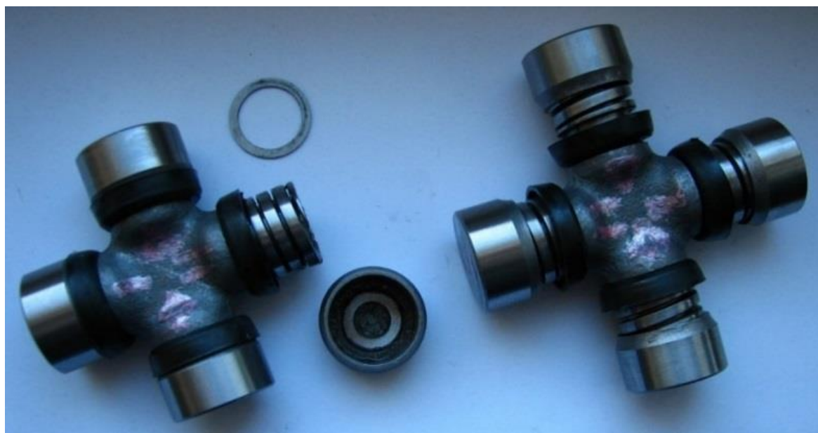
Рисунок 4.6 - Крестовины автомобиля ВАЗ (классика) с установленными пружинными вкладышами
