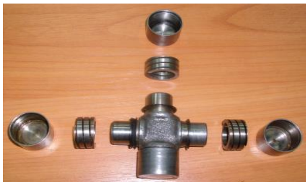
Рисунок 4.5 - Крестовина автомобиля ВАЗ «Нива» с установленными пружинными вкладышами
