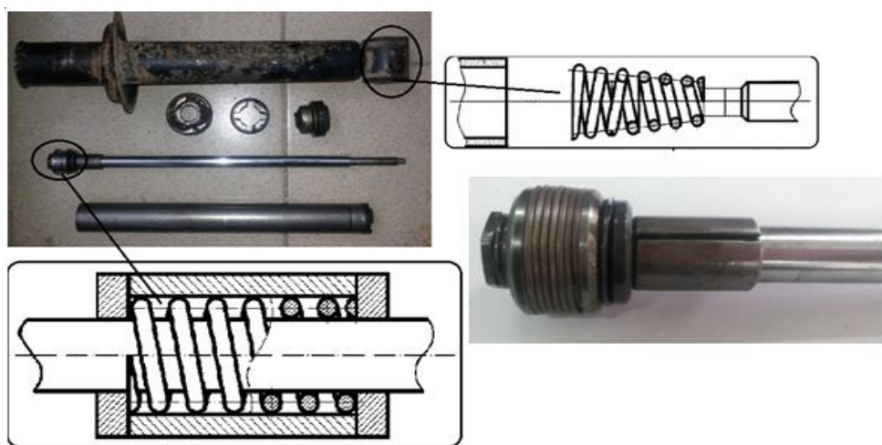
Рисунок 4.7 - Задний амортизатор автомобиля ВАЗ: ремонтный комплект поршня с уплотнением из винтовой цилиндрической пружины квадратного сечения с поджатыми витками
