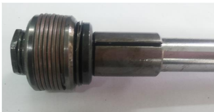
Рисунок 2.4 - Поршень в сборе с уплотнительным омедненным пружинным вкладышем
