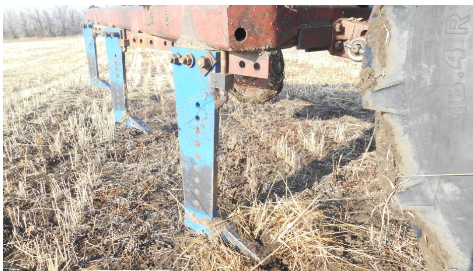
Фото1- Орудие «РАНЧО» с расстоянием между стойками 0,7м
