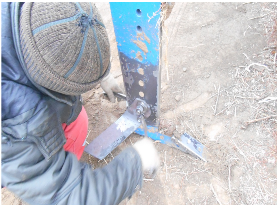
Фото9 – Регулировка подрезающей лапки «РАНЧО»
