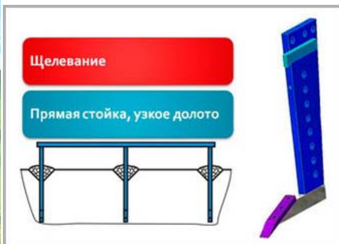
Рисунок 1 - Вариант использования РАНЧО для щелевания – прямая стойка, узкое долото
