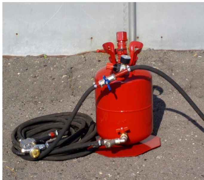
Рисунок 2 - Переносной консервационный распылитель ПРК-1-2
