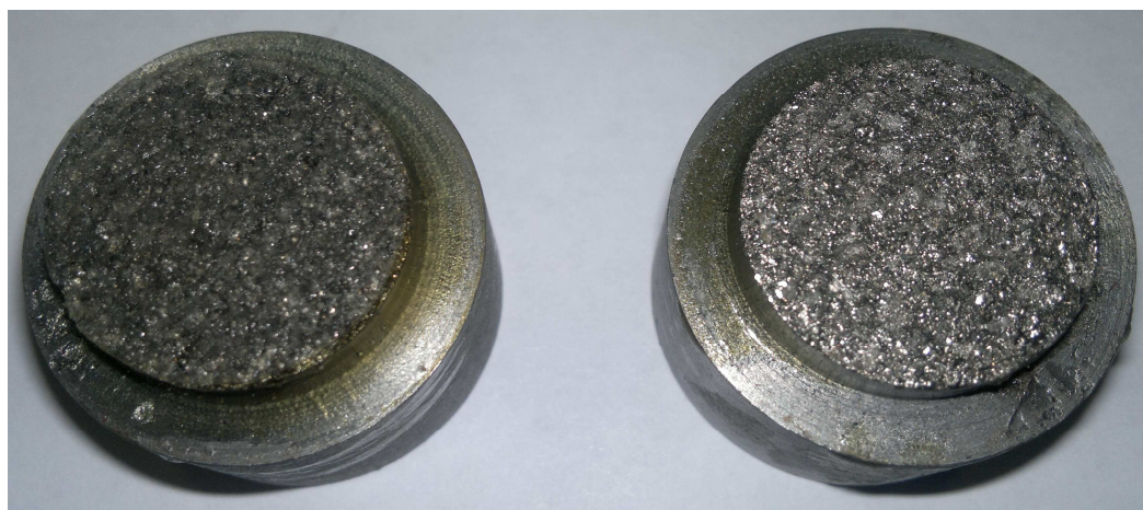
Рисунок 4 – Образцы, прошедшие испытание на прочность сцепления
