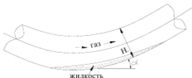
Рисунок 1 - Пониженный участок газопровода с жидкостным скоплением
