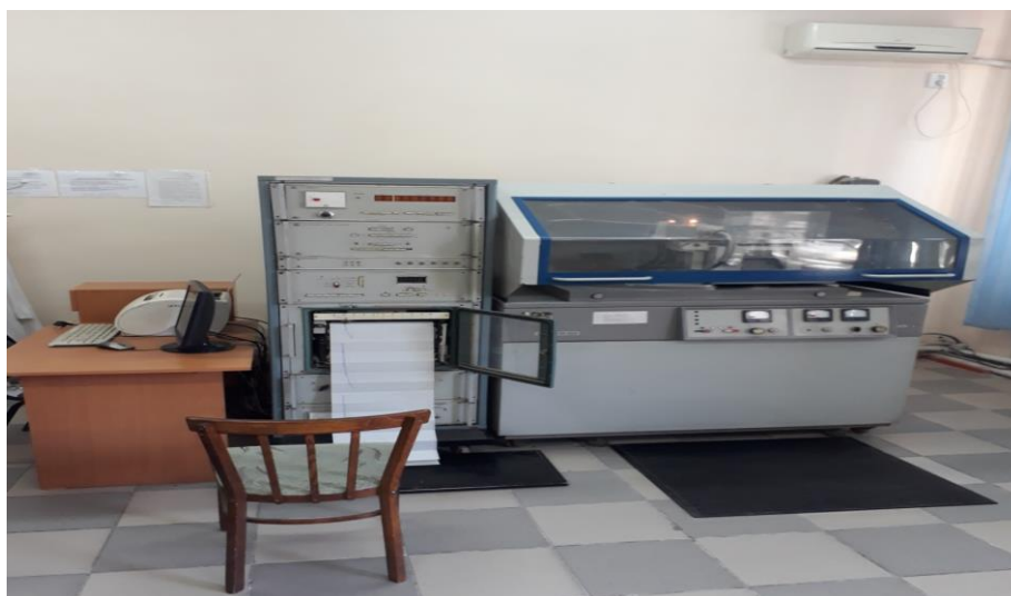
Рисунок 3 – Аппарат рентгеновский ДРОН-3
