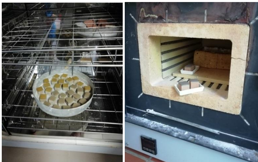
Рисунок 3 – Образцы после нанесения глазури в сушильном шкафу и в электрической печи
