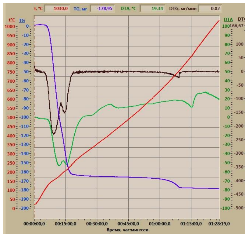
Рисунок 1 – Кривая ДТА образца гипсового камня
