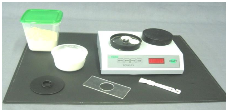
Рисунок 1 – Прибор «Белизномер Блик Р3» для определения белизны пшеничной и ржаной муки
