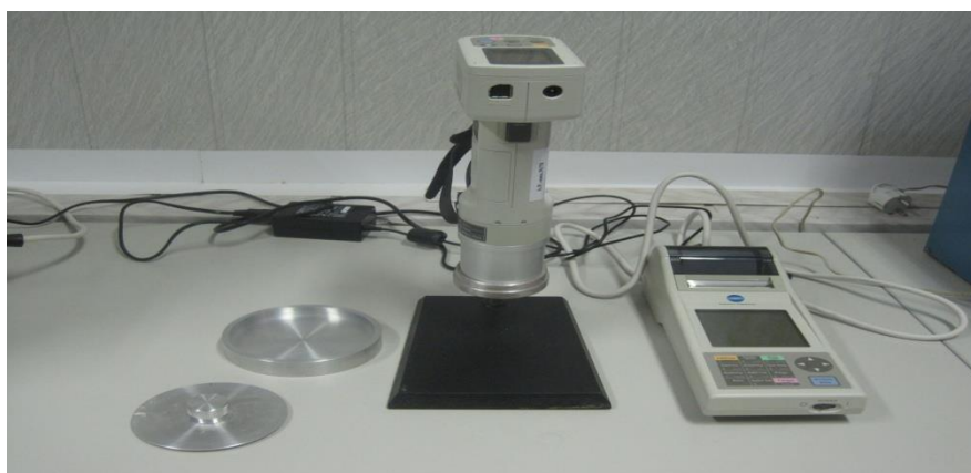
Рисунок 2 – Прибор для определения цветовых характеристик муки «Chroma meter CR-410» - фирма «Konica Minolta» - Япония
