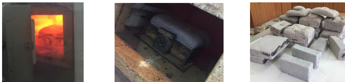
Рисунок 1 - Опытно-лабораторные образцы пеностекла
